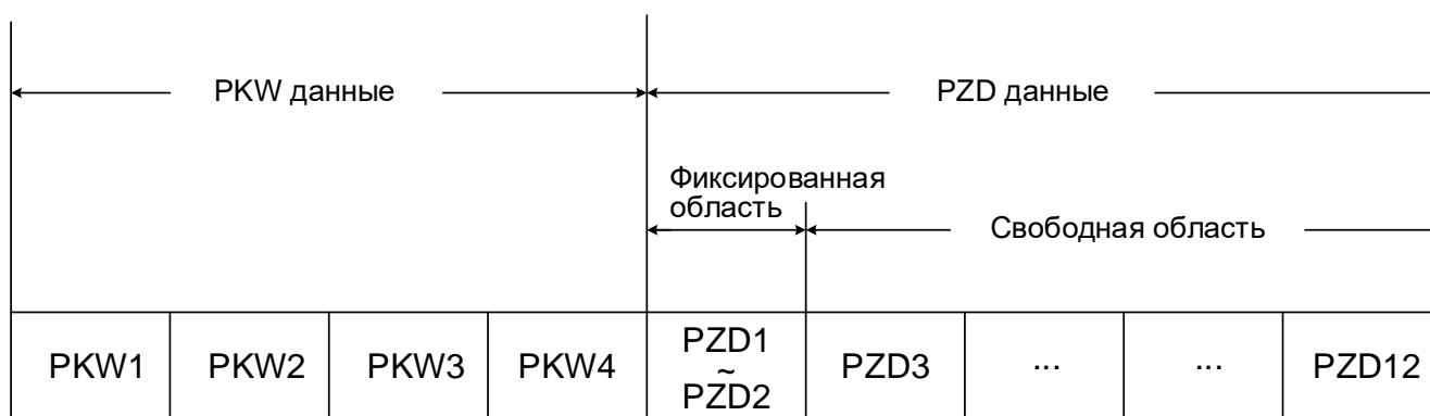
Рисунок 3-1 Структура данных информационного кадра Profibus-DP
