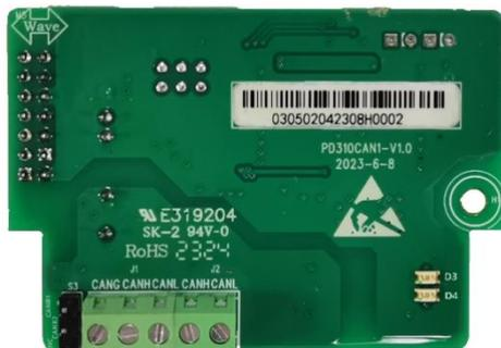
Рисунок 2-1 Интерфейс PD310CAN1
