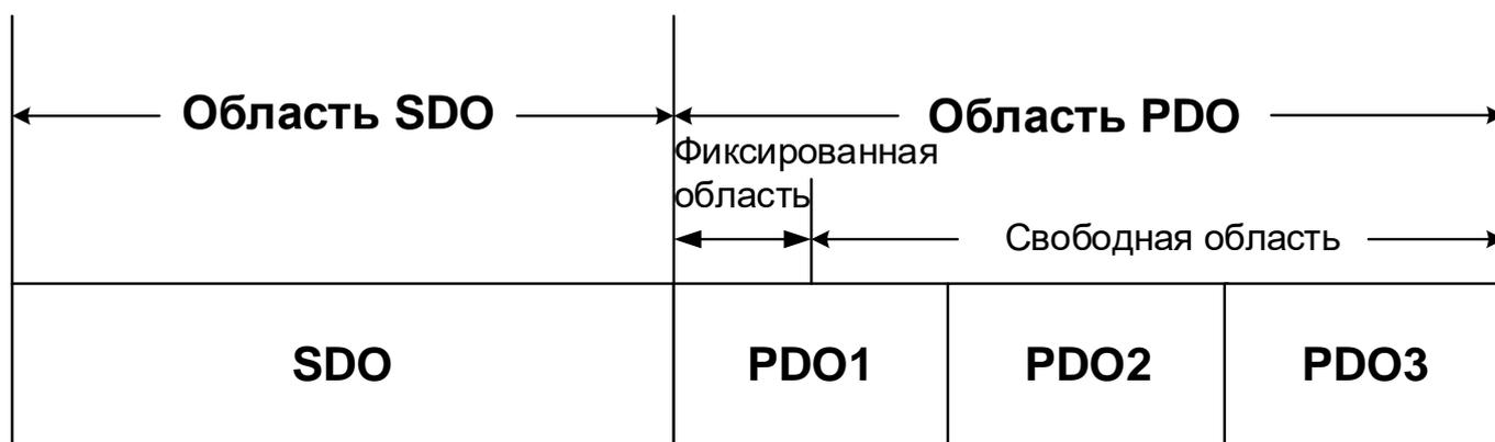
Рисунок 3-1 Структура данных информационного кадра CANopen PD310CAN
